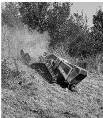
Seit einigen Tagen ist im Bauhof die neue Mähraupe im Einsatz. Mit Hilfe einer Fernsteuerung wird die Mähraupe geführt und eignet sich somit zur Pflege von steilen Böschungen und Hängen. Durch den Raupenantrieb kann sie auch schwieriges Gelände befahren.
